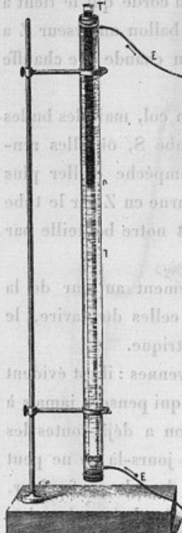
46. — Sur un dispositif qui permet de mesurer l'intensité de la lumière qui pénètre dans les eaux.
