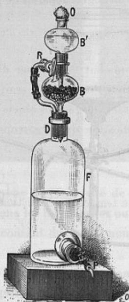
suffirait pour produire ce résultat. Nous employons dans notre laboratoire des flacons dont le bouchon hermétique est surmonté d'un minuscule appareil à production constante d'hydrogène pur qui vient prendre la place du liquide au fur et à mesure qu'on le soutire par en bas. Ce dernier n'est donc jamais en contact avec l'atmosphère.
