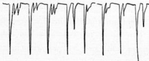
Fig. 26. — Même chariot avec fer doux et interrupteur sec du commerce. — Il se produit des irrégularités considérables.
