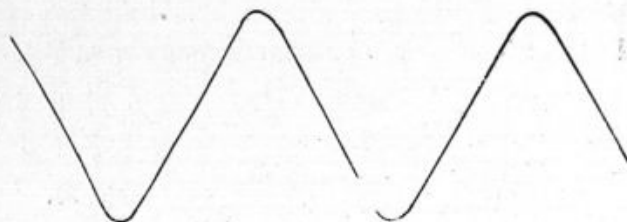
Fig. 54. — Petite dynamo médicale à bobines fixes et aimant mobile. Tracé pris sans résistance extérieure.
