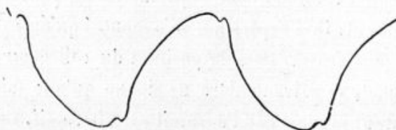
Fig. 56. Même machine. Résistance extérieure liquide de 9 000 ohms environ.
