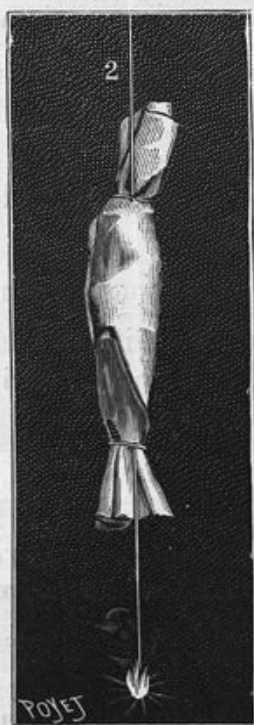
Fig. 38. — Dispositif d'allumage des photopoudres, Cartouche en papier Bengale.
