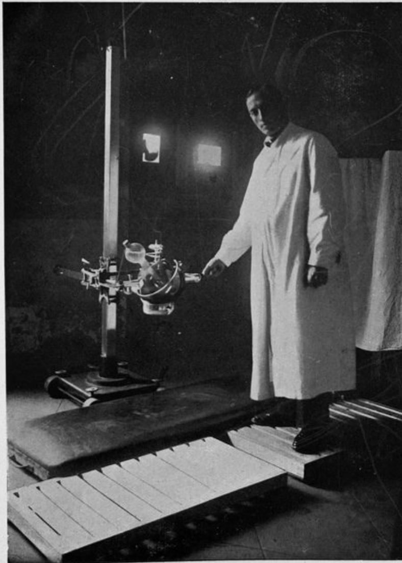
Le radiographe, placé sur la plate-forme isolante, prend à pleine main le fil du tube en fonction donnant des rayons N° 6. Aucune sensation.
