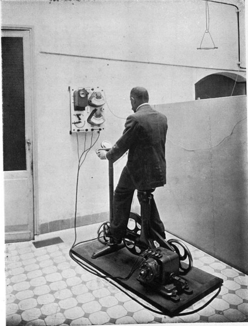
Électrothérapie active. Mesure de tous les facteurs du travail : temps, effort, puissance, énergie totale, vitesse, etc.
