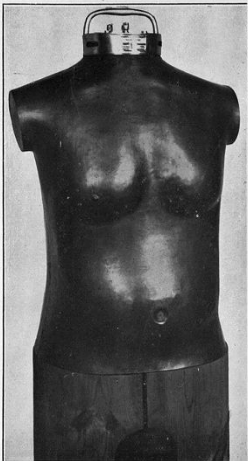
Buste en cuivre rouge noirci moulé sur le sujet porteur de vêtements à mesurer. Le vêtement est traversé par un courant d'eau chauffée à 37° à l'entrée; elle ressort, après avoir été agitée, après avoir perdu une certaine quantité de chaleur, d'où l'on déduit le coefficient de rendement du vêtement.
