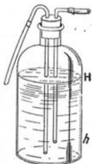
FIG. 54. — Flacon de Mariotte ordinaire, non adapté à un fonctionnement discontinu en milieu chaud.
