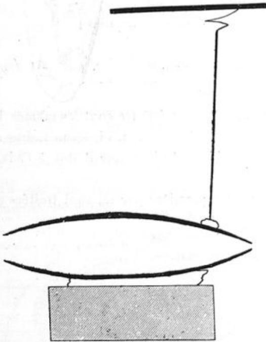
FIG. 63. — Représentation schématique du dispositif que j'ai employé à la Station physiologique du Collège de France pour l'inscription graphique du mouvement des valves chez les Acéphales. — (Un stylet muni d'une aiguille inscriptrice est fixé sur la coquille, et la pointe de l'aiguille trace le mouvement sur une plaque de verre enduite de noir de fumée.)
