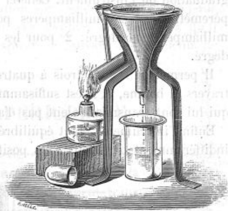
Fig. 21. — Entonnoir pour la filtration à chaud.
