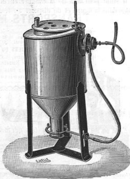
Fig. 29. — Étuve autorégulatrice de M. d'ARSONVAL.
