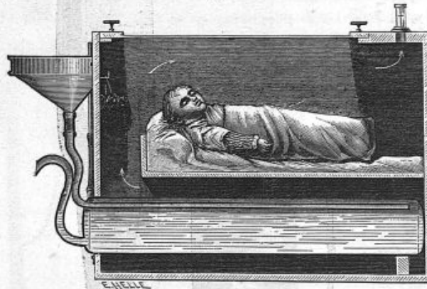
Fig. 102. — Couvere modèle 1889. Coupe.
