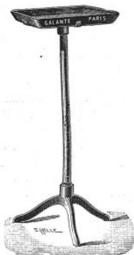
Fig. 1. — Trépied porte-cuve, à hauteur fixe ou variable.
