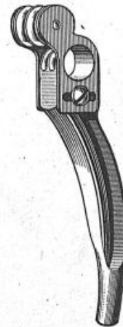
Cette pièce métallique présente un trou de passage pour l'axe de l'appareil ; au-dessus de ce trou sont deux roulettes en bois (fig. 33).
