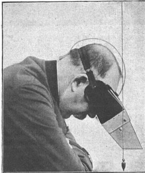
Position de l'observateur coiffé du manudioscope. Le fil à plomb représente le rayon normal qui se rapproche le plus du visage de l'observateur (fig. 2).
