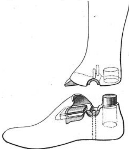
Un cylindre en caoutchouc à l'arrière, une plaque de même matière à l'avant assurent le jeu de l'appareil (fig. 24).
