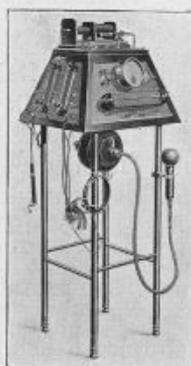
disques tournent tous du même sens et sont entraînés directement par le moteur, ne comporte, bien entendu, aucune courroie. Il en ressort donc cette triple supériorité d'une plus grande vitesse (le modèle présenté tourne à 2.000 tours), d'un débit intense et d'une marche plus silencieuse que toute autre machine.
