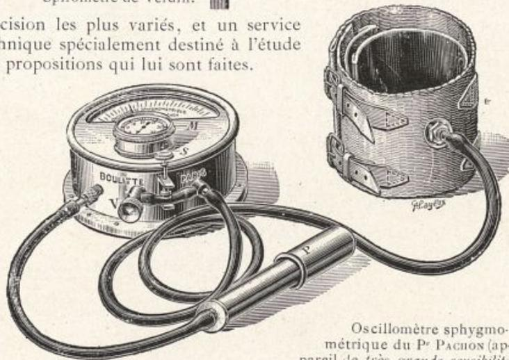
Oscillomètre sphygmométrique du Pr PACHON (appareil de très grande sensibilité pour la mesure de la pression artérielle, *maxima* et *minima*, construit sur un principe entièrement nouveau).
