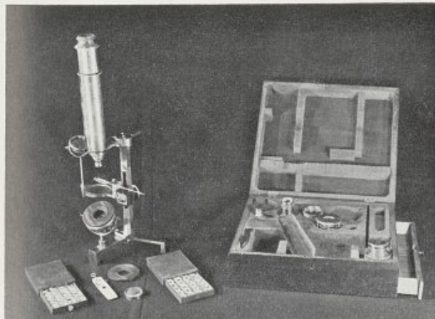
Abb. 2. Achromatisches Mikroskop von HARMANUS VAN DEIJL mit Zubehör. Katalognummer M 8 b von „Het Nederlandsch Historisch Natuurwetenschappelijk Museum“ zu Leiden.
