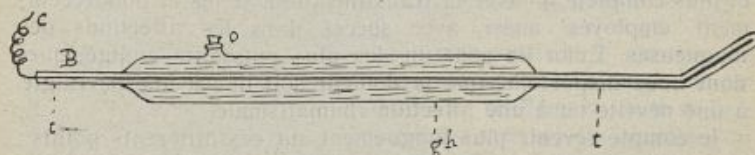
Fig. 2. — Électrode du Dr Oudin pour courants de haute fréquence, modèle B : t, tube de verre central ; gh, gaine de verre ; o, orifice servant à introduire l'huile dans la gaine ; c, fil de cuivre et tige de cuivre passant dans le tube central (1/4 grandeur vraie).
