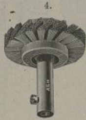
Brosse en fil d'acier se montant sur l'extrémité du câble du tour à fraiser.
