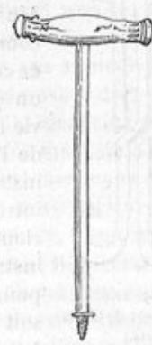
Fig. 1404. Tarière avec arrêt.
