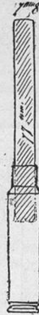
Fig. 10. — Cartouche d'infanterie à longue balle d'acier pour le tir contre les fils de fer.
