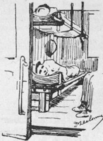
Fig. 95. — Appareils à suspension sans ressorts. Type Etat. Blessés couchés et assis.
