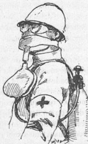
Fig. 37. — Soldat muni d'un appareil d'inhalation Draeger pour la recherche dans les fosses.
