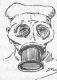
Fig. 37. — Soldat muni d'un appareil d'inhalation Draeger pour la recherche dans les fosses.
