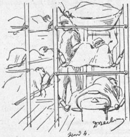
Fig. 98. — Appareils de suspension pour blessés, à cadres métalliques et à ressorts modèles Brechot-Desprès-Ameline réglementaires. Type Nord 4.
