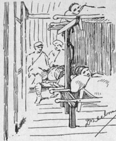
Fig. 96. — Appareils à suspension sans ressorts. Type Etat. Blessés couchés et assis.
