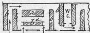
Fig. 94. — Aménagement d'un wagon de blessés assis (W. C. T., Nord). b, b, b, b, bancs. — bd, brancard. — a, table. — wc, water-closets.
