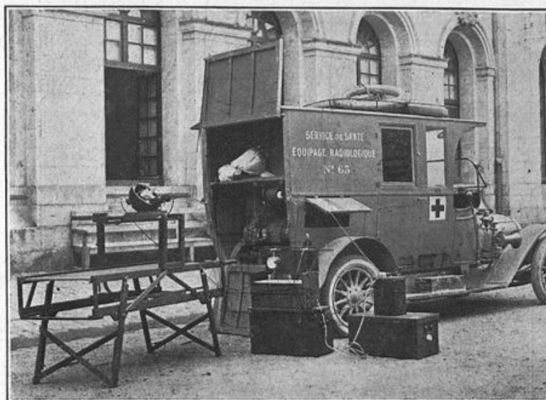
Fig. 120. — Voiture radiologique aménagée avec groupe électrogène. (Phot. MASSIOT).
