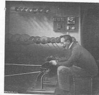
Fig. 241. — Ouvrier limant les ressorts sur une meule mue par un moteur électrique.
