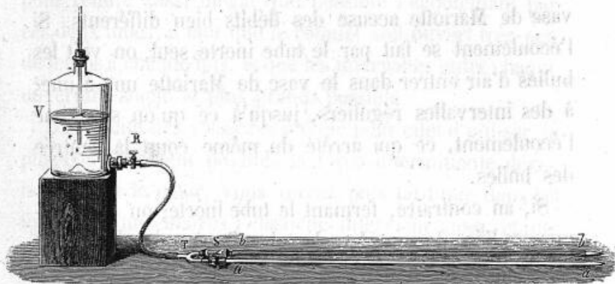
FIG. 6. — Schéma du rôle de l'élasticité artérielle.
