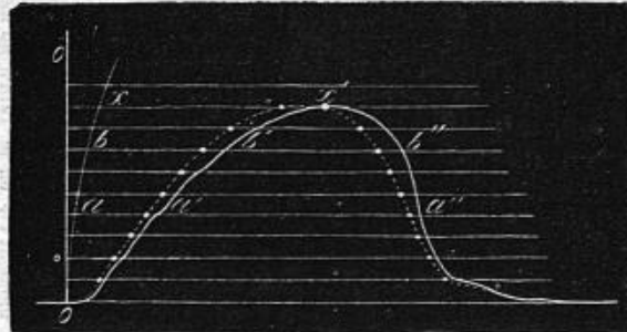
FIG. 54. — Correction de l'arc de cercle dans un graphique.
