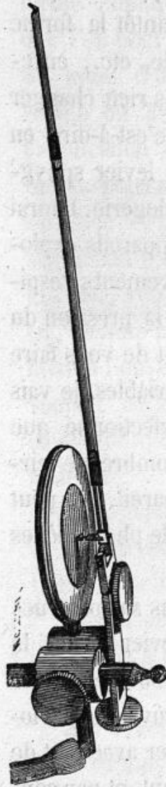
FIG. 44. — Levier du polygraphe articulé avec la membrane du tambour.
