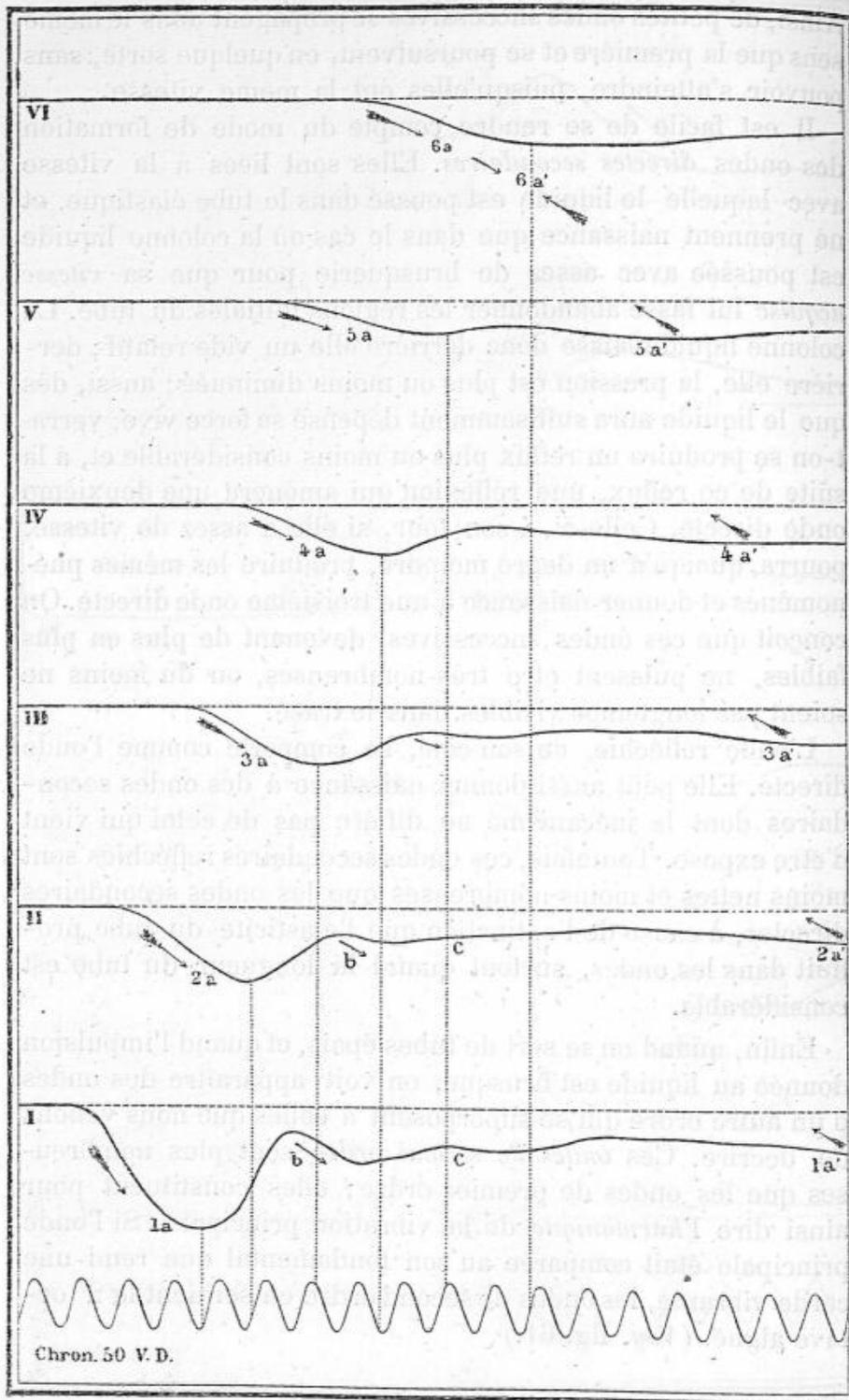
Fig 62. — Onde négative dans un tube fermé.
