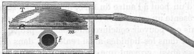
Fig. 58. — Montrant la disposition d'un des explorateurs de l'onde.
