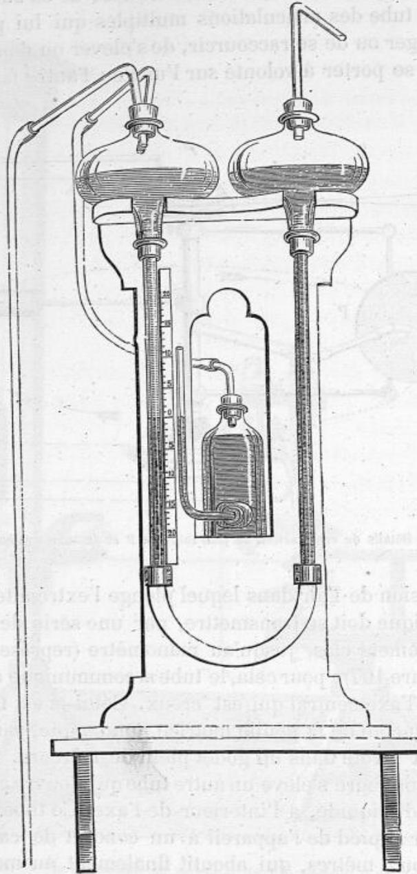
Fig. 109. — Manomètre à deux liquides.
