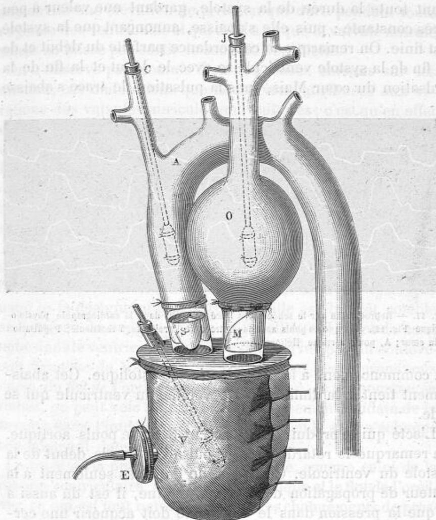
Fig. 46. — Disposition du schéma pour reproduire les tracés de la cardiographie physiologique.
