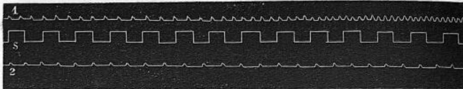
Fig. 89. — Tracés du compte-gouttes : ligne supérieure, liquide versé par le tube de droite; ligne inférieure, liquide versé par le tube de gauche. (Expérience faite sur deux conduits qui versaient de l'eau avec des débits variables.)
