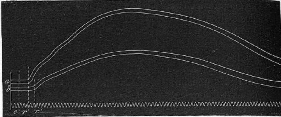
Fig. 80. — Mesure de la vitesse de l'agent nerveux. Chronographe de 230 vibrations doubles  $e$ , moment de l'excitation du nerf. —  $r$ , retard de la secousse quand on excite le nerf très-près du muscle. —  $r'$ , retard quand on excite le nerf plus loin du muscle. ( $r' - r$  mesuré au chronographe, exprime le temps que l'agent nerveux a mis à parcourir la longueur de nerf qui sépare les deux points excités).
