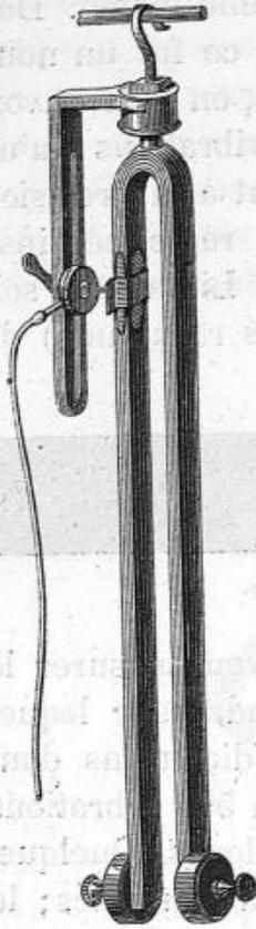
Fig. 72. — Diapason de 10 vibrations doubles disposé pour envoyer ses vibrations à un tambour à levier.
