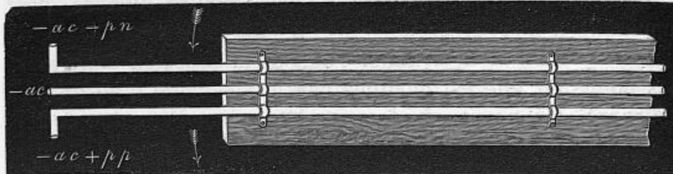
FIG. 410. — Extrémités des tubes manométriques disposés sur une planchette qui forme le bras d'un manège tournant de 3 mètres de rayon. Des flèches indiquent le sens de la rotation.
