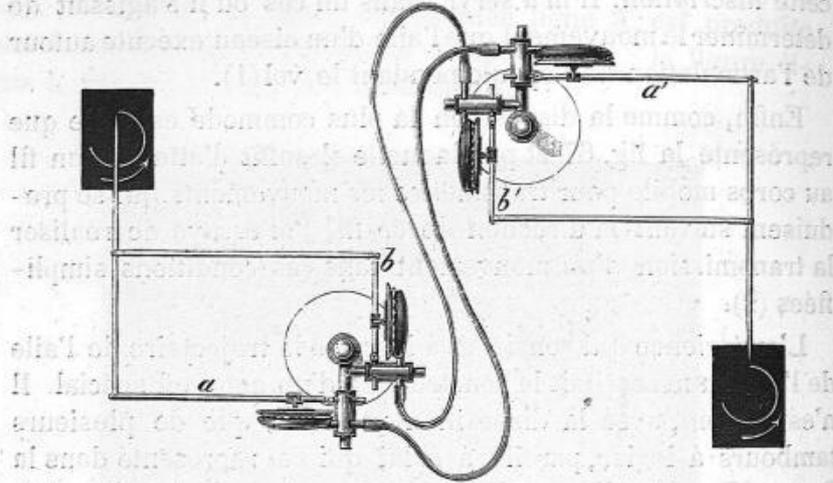
Fig. 69. — Pantographie à transmission du mouvement par l'air. L'appareil est vu d'en haut.
