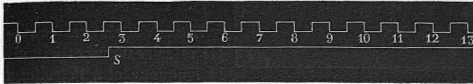
Fig. 77. — Ligne supérieure : tracé des secondes, 1, 2, 3, etc., inscrites électriquement. — Ligne inférieure : signal d'un phénomène; il se produit à l'instant S.
