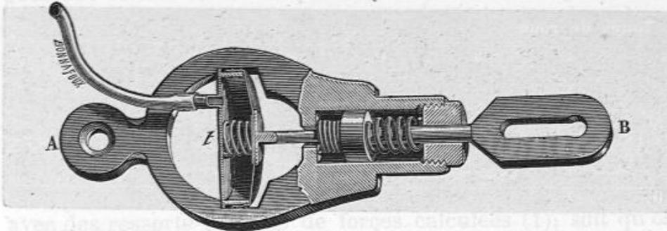
Fig. 2. — Dynamographe ou dynamomètre inscripteur transmettant à distance les indications des efforts de traction.
