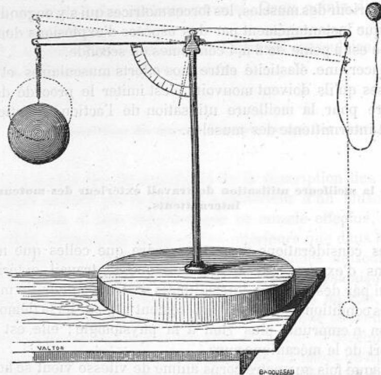
Fig. 4.— Appareil destiné à montrer qu'une *force vive*, directement appliquée au déplacement d'une masse, s'éteint dans un choc, tandis que la même force, transmise par un intermédiaire élastique, peut effectuer du travail. (Figure empruntée à l'ouvrage intitulé: *Du Mouvement dans les fonctions de la vie*, 1868).
