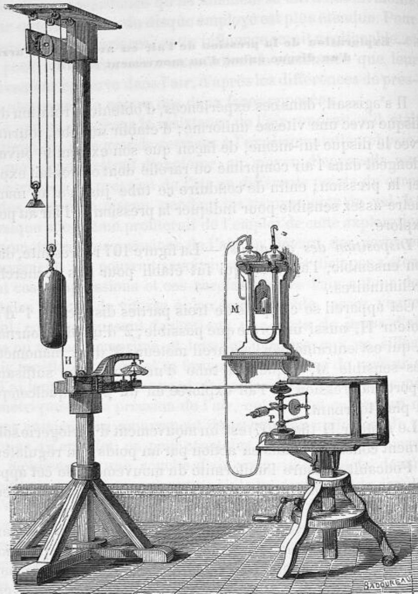
Fig. 407. — Vue d'ensemble du moteur H, du plan tournant P, des tubes manométriques et du manomètre M.
