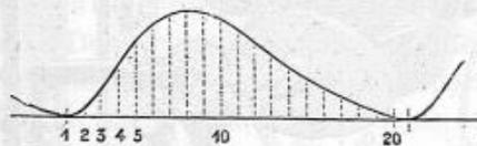
Fig. 43. — Courbe de la systole ventriculaire avec les 20 ordonnées qui serviront à la construction de la came.
