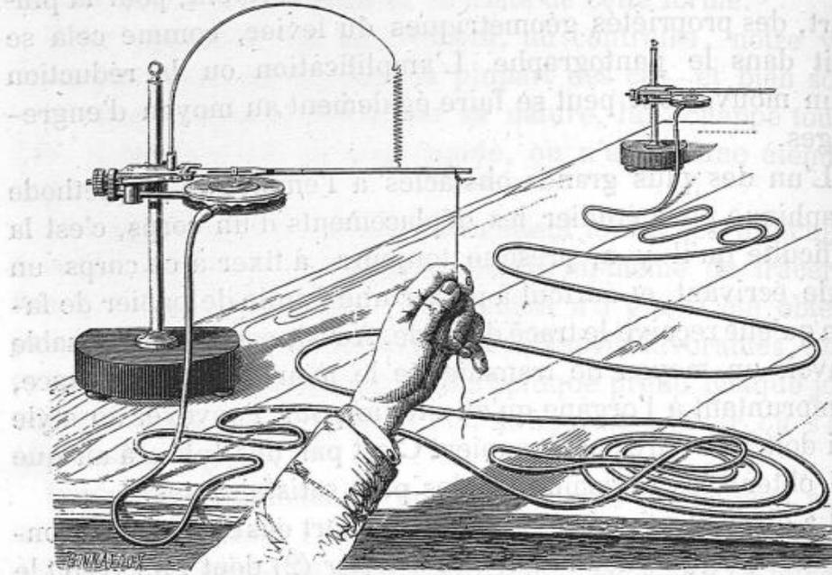
Fig. 67. — Leviers conjugués pour la transmission des mouvements à distance.
