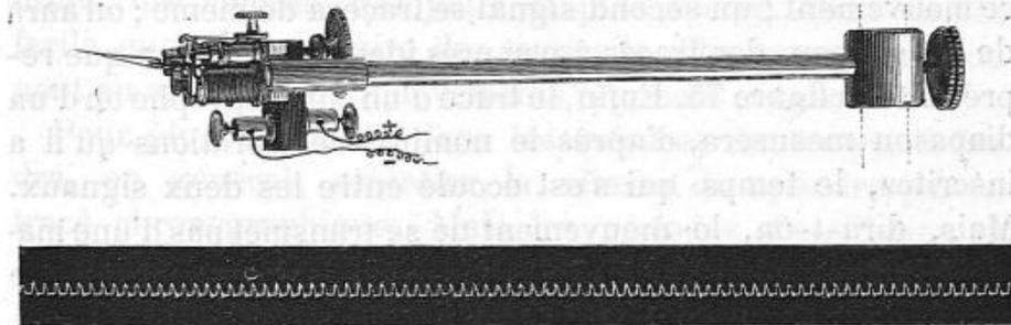
Fig. 76. — Appareil à signaux électriques de M. Deprès; Signaux de cet appareil actionné par un diapason interrupteur de 500 vibrations simples par seconde. (Héliogravure.)
