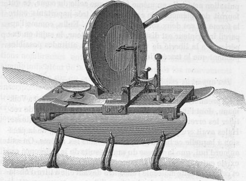
Fig. 142. — Sphygmographe à transmission.
