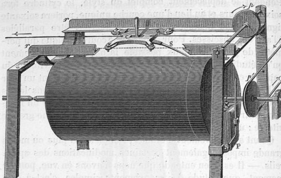
Fig. 124. — Appareil pour inscrire un mouvement rectiligne quelconque.
