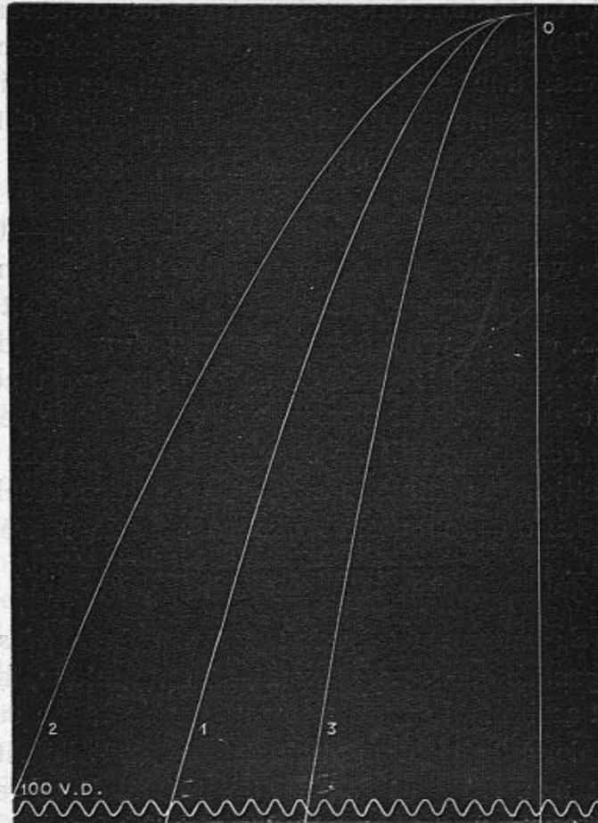
Fig. 126. — Courbe de la chute des corps. 1. Chute sous l'influence de la pesanteur. 2. Chute sous l'influence d'une force égale à la moitié de la pesanteur. 3. Chute sous l'influence d'une force égale au double de la pesanteur.
