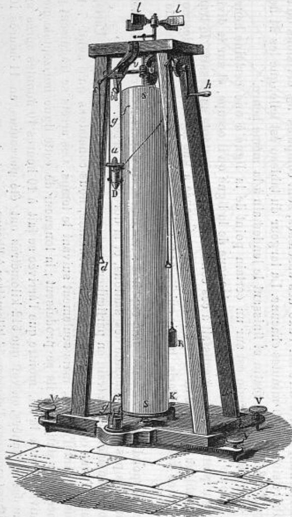
Fig. 123. — Machine de Foncelet et Morin pour inscrire le mouvement d'un corps qui tombe
