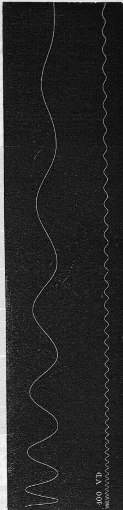
Fig. 419. — Tracé des oscillations de l'aile de l'oiseau artificiel. Au dessous, vibrations du chronographe. On voit de gauche à droite les changements produits par l'accroissement de la vitesse de translation de l'oiseau. (Réduction photographique.)
