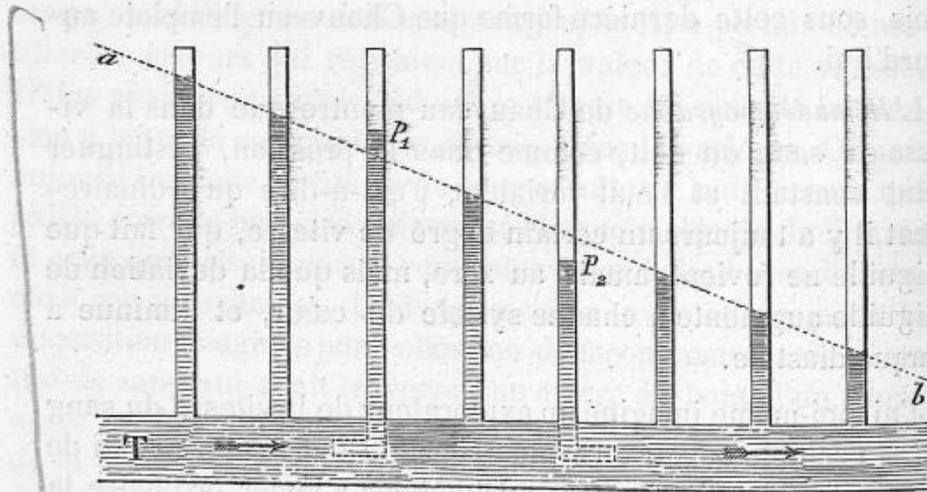
Fig. 143. — Tube T dans lequel se fait un écoulement de liquide dans le sens des flèches *a, b*, niveaux d'une série de piézomètres. — *P1* et *P2*, tubes de Pitot, diversement orientés; leurs niveaux diffèrent de ceux des piézomètres.
