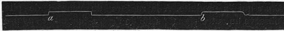
Fig. 14. — a tracé imaginaire d'un courant infiniment intense. — b tracé réel du courant d'un élément Bunsen.
