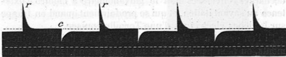
Fig. 19. Tracés de courants induits signalés par l'électromètre capillaire, d'après une photographie grandie deux fois.
