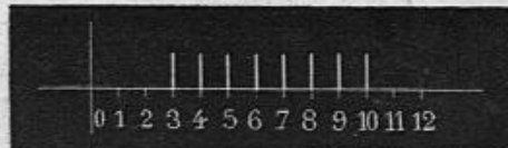
Fig. 3. — Destinée à expliquer la manière dont on mesure la durée d'un courant électrique au moyen d'explorations successives.
