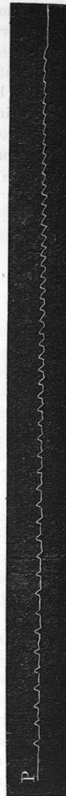
33. — Décharge composée de flux de fréquence croissante; on voit l'addition de ces flux se prononcer graduellement
