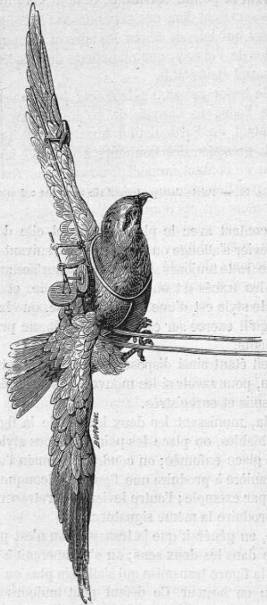
Fig. 99. — Buse volant avec l'appareil qui signale les mouvements décrits par l'extrémité de son aile.
