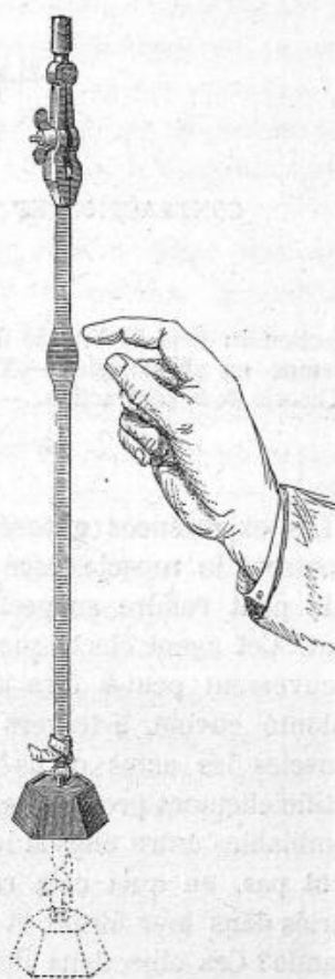
Fig. 9. — Transformation de la chaleur en travail par un fil de caoutchouc.
