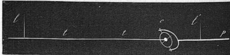
Fig. 108. — Figure théorique de l'appareil explorateur des mouvements de torsion de l'aile.
