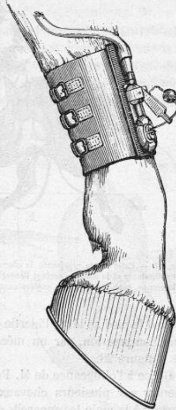
Fig. 43. — Appareil destiné à signaler les appuis et levés du sabot du cheval.
