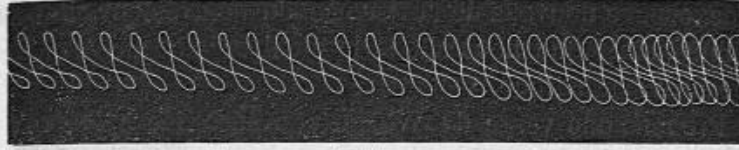
Fig. 76. — Graphique d'une verge de Wheatstone accordée à l'octave, c'est-à-dire vibrant deux fois transversalement pour chaque vibration longitudinale (figure empruntée à R. Kœnig). Le ralentissement du cylindre produit la condensation des courbes vers la fin du graphique.
