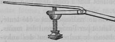
FIG. 66. — Vis de pression de Jules Guérin, servant d'arrêt au redressement obtenu.
