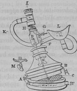
FIG. 25. — Appareil de Lüer. — A, charnière ; — B, récipient supérieur ; — B', récipient inférieur ; — C, diaphragme ; — D, bouton servant au mouvement d'élévation et d'abaissement du diaphragme ; — E, tube de dégagement ; — F, ouverture pour l'entrée de l'air atmosphérique ; — G, soupape à tiroir pour régler la proportion d'éther ; — H, soupape sphérique inférieure ; — K, soupape sphérique supérieure ; — J, tube conducteur ; — L, embouchure ; — M, pince-nez.
