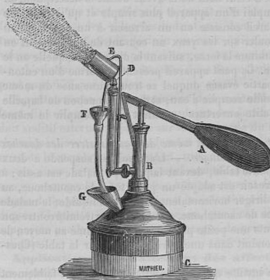
FIG. 40. — C, Vase en cristal dans lequel on verse par l'entonnoir. — G, Liquide simple ou médicamenteux qui peut être employé à des températures variées. — B, Corps de pompe portant un clapet au point où il s'adapte avec le tube d'aspiration. — A, Levier destiné à faire, à l'aide du piston, la pression immédiate sur le liquide; ce levier se dévisse à volonté au point L. — I, Tube emmanché sur le corps de pompe et se terminant en haut, au point K, par un pas de vis destiné à recevoir les différents ajustages (ajustage fixe, tube en étain, etc., etc.) perforés pour le passage de l'eau.
