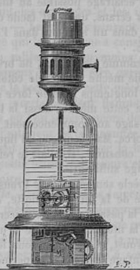
FIG. 15. — Lampe Carcel à réservoir de cristal. — R, Réservoir d'huile; C, Caisse faisant fonction d'une pompe aspirante et foulante; o, o', Ouvertures fermées par des sacs en baudruche. Les extrémités de ces sacs sont fixés sur deux pistons, dont le mouvement alternatif est produit par un mécanisme d'horlogerie M, fixé au-dessous. L'huile est chassée par les clapets c, c', dans le tuyau T, jusqu'au bec de la lampe b.
