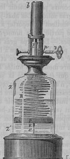
FIG. 16. — Lampe modérateur à réservoir de cristal. — P, Piston en cuir embouti qui s'appuie sur la paroi z, z'. Ce cuir est traversé par un tube extensible R, t, t', qui contient une tige conique a. Une crémaillère c, qui engrène sur le pignon p, permet de relever le piston P, en tendant le ressort R. Ce ressort, en se distendant, fait monter l'huile par le tube t; la tige conique a modère l'ascension.
