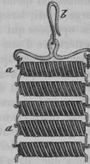
FIG. 52. — Mise en activité de la pile de Pulvermacher.
