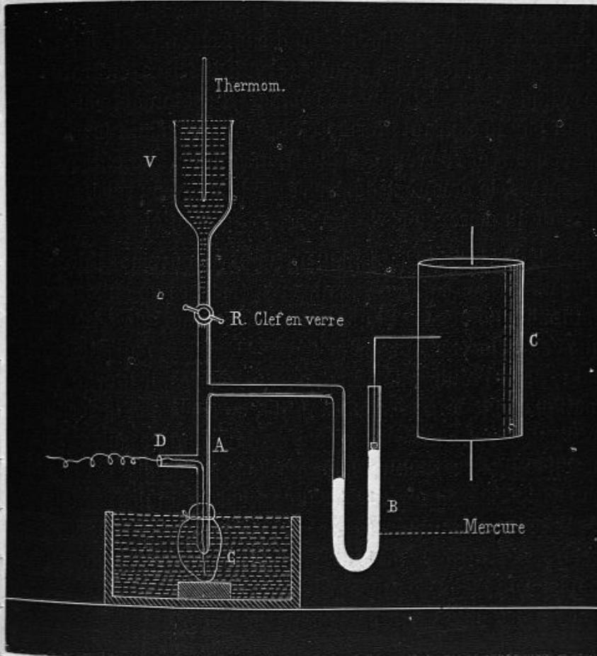
Fig. 70. — Schéma figurant l'expérience de Bowditch.
