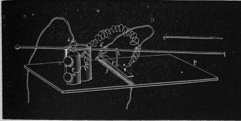
Fig. 81. — Myographe à tige de paille. — P, support de liège. — *q*, *q'* style écrivain, fait d'une paille munie en arrière d'un contrepoids de cire à modeler. — *t*, tiges de paille reliée au levier de paille. — O, bouchon encoché sur lequel le style a son centre de mouvement. — C, borne électrique, *b*, son fil. — *p*, plaque métallique supportant le muscle excité; *b*, son fil. — *a a'* fil reliant la borne et la tige *t*.
