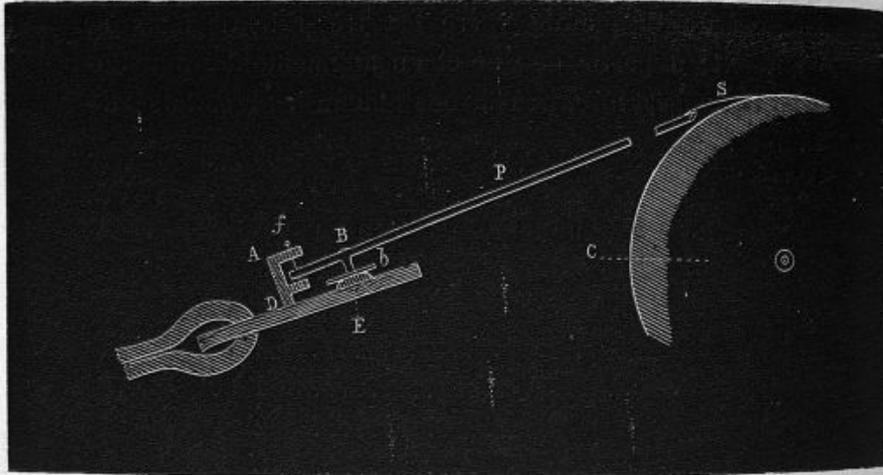
Fig. 98. — Appareil pour enregistrer le mouvement des cils vibratiles. — E, lame de liège portée sur un support à mâchoires. — AE, armature verticale. — *f*, axe du mouvement formé par une épingle. — P, Tige de paille portant un style en S. — B, tige de paille à angle droit avec la paille porte-style. — *b*, lamette de verre en contact avec la membrane ciliée. — C, cylindre enregistreur.
