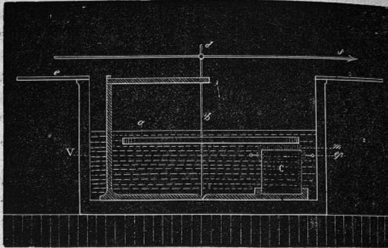
Fig. 97. — Appareil enregistreur mesurant la vitesse du mouvement des cils vibratiles. — *a*, disque de verre. — *b*, son axe portant en *d* un style de paille *ds*. — *V*, cristalliseur de verre. — *e*, coupe du cadran divisé qui l'entoure. — *C*, bouchon de liège portant la membrane ciliée *m* fixée par des épingles, *ep*. — Les hachures parallèles en pointillé figurent l'eau salée.
