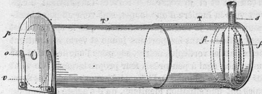
Fig. 23. — *Myospectroscope*. — *p*, platine sur laquelle on fixe la préparation à l'aide de valets *V*; *T'*, tube principal à une des extrémités duquel se trouve la fente *f* du spectroscope. *T*, Tube que l'on ajoute pour l'examen spectroscopique du sang, à l'extrémité libre duquel se trouve la fente *f'* dans laquelle est engagé le tube à analyses contenant la solution de sang.
