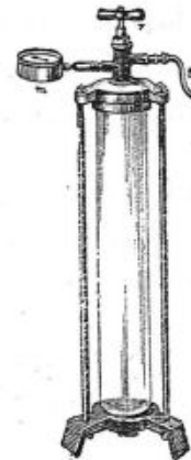
Fig. 97. — Appareil servant à comprimer l'oxygène à 5 atmosphères.
