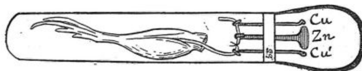
Fig. 174. — Pistolet électrique de du Bois-Reymond.
