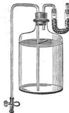
Fig. 88. — Flacon spécial pour la conservation de la solution tirée de baryte (d'après Gilkinet, Pharmacologie ).
