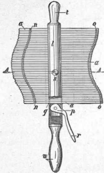
FIG. 70. — Conformateur à main.
