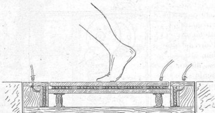
FIG. 66. — Coupe du dynamographe montrant la disposition pour explorer la pression normale et les pressions tangentielles en avant et en arrière du pied sur le sol.
