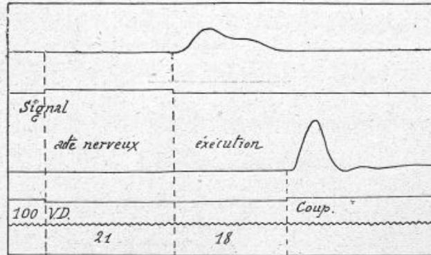
FIG. 95. — Disposition pour mesurer la vitesse du coup de poing et tracés obtenus donnant en 100<sup>e</sup> de seconde la durée relative de l'acte nerveux et celle de l'exécution avec l'intensité du coup.
