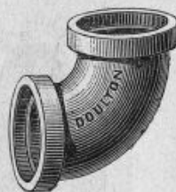
Fig. 23. — Coude en plomb (B A C fig. 24) réunissant le tuyau du réservoir de chasse E D à la bague en caoutchouc et à la douille de la cuvette.
