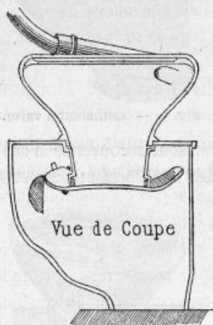
Fig. 4. — Coupe de la cuvette à douille et de l'obturateur.
