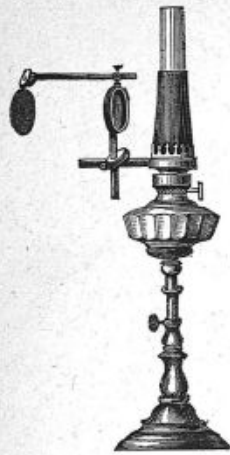
Fig. 7. — Appareil de Boecker (tige fixée par une vis).
