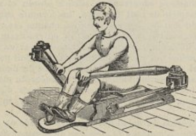
Fig. 240. — Appareil de chambre, canotage avec résistance réglable.
