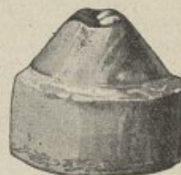
Fig. 104. — Estampe en métal de Wood d'après le modèle fig. 103.
