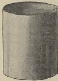
Fig. 279. — Forme en fer pour couler les estampes.
