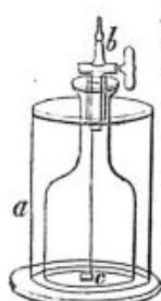
Avec un instrument de ce genre , un mélange qui contenait en dis solution un grain d'arsenic dans vingt-huit mille grains d'eau , m'a donné plus de cent croûtes bien évidentes d'arsenic métallique.
