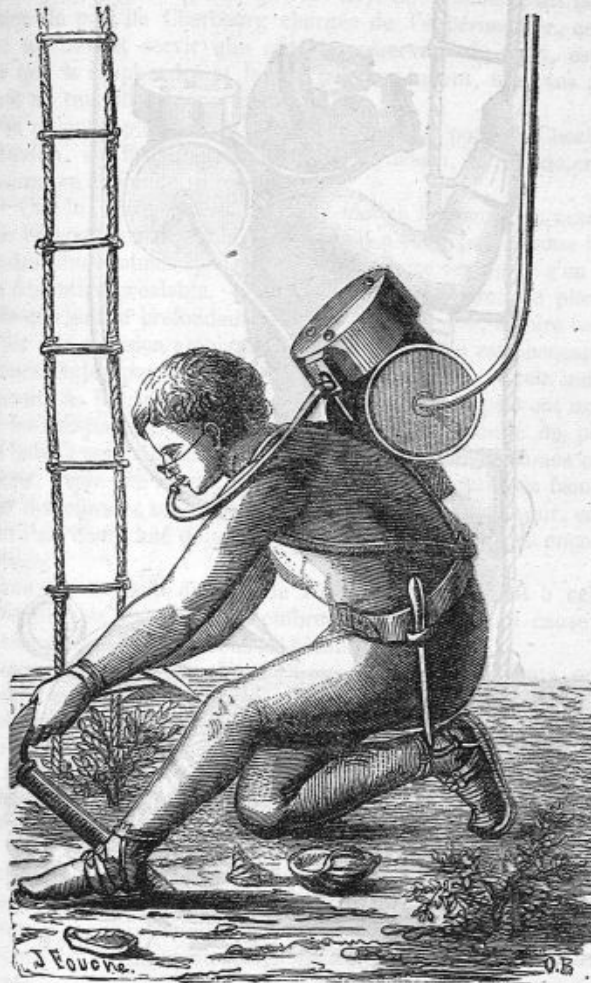
Pl. XVII. — Appareil plongeur Rouquayrol-Denayrouse, sans masque et sans vêtement.
