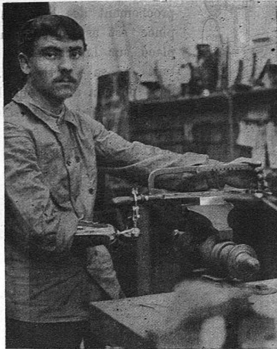
Fig. 2. — Travail à la scie (avec la pince avec articulation à noix).
