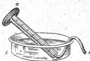
Fig. 1. — a, éprouvette graduée remplie d'eau et reposant inclinée sur le rebord du récipient ; — b, récipient également rempli d'eau pour empêcher l'éprouvette de se vider ; — c, tube en caoutchouc dont une des extrémités plonge dans l'intérieur de l'éprouvette graduée et dont l'autre extrémité est introduite dans la narine ou dans la trachée du sujet en expérience ; à l'ouverture de la poitrine, l'air résiduel pénètre dans l'éprouvette et vide cette dernière d'une quantité d'eau qui sera d'autant plus grande que le retrait pulmonaire sera plus prononcé.
