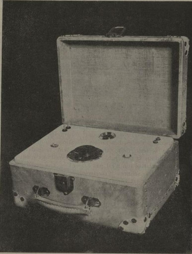
crise on appuie sur le bouton poussoir de droite. Par l'intermédiaire de ce bouton, on établit le courant qui s'interrompt automatiquement lorsque l'énergie voulue est utilisée. Pendant la phase électrique du traitement la lampe témoin s'éteint pour s'allumer de nouveau lorsque le courant de choc est interrompu.
