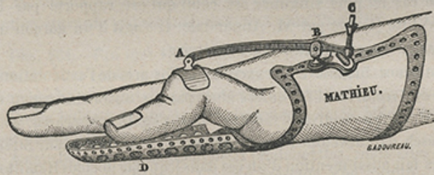
Fig. 15. — A. Plaque garnie d'un coussin. B. Charnière du levier. C. Vis au moyen de laquelle on exerce la pression sur la plaque A. D. Gouttière destinée à servir de point d'appui au doigt lorsqu'il s'allongera.
