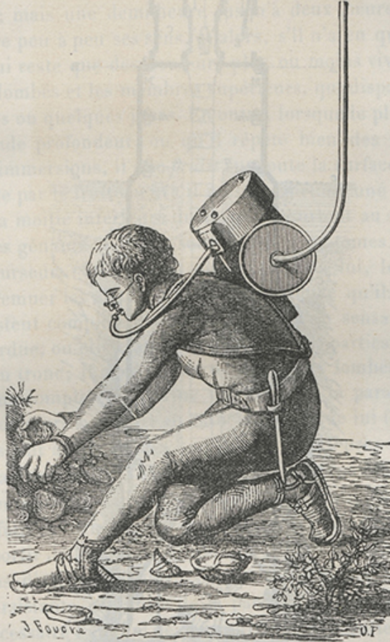
Scaphandrier pourvu du régulateur Denayrouze, ayant ôté son masque.
