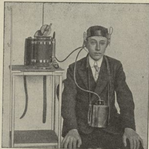
FIG. 22. — Le statokinètre employé en position assise.
