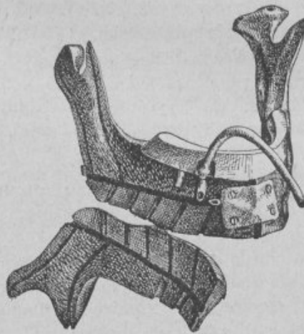
Figure 1. — Maxillaire inférieur artificiel montrant la distribution des canaux d'irrigation ménagée dans son épaisseur. Une plaque réunit au centre le côté droit et le côté gauche, le moignon de la face triturante est distinct du corps de l'appareil.
