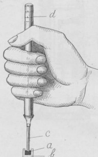
FIG. 5. — Fouloir dynamomètre pour l'étude et le contrôle des pressions à exercer pendant la mise en place de l'amalgame.
