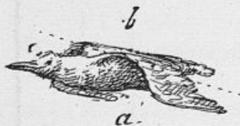
Fig. 125. — Figure théorique montrant l'inclinaison de la surface de l'aile de l'oiseau.
