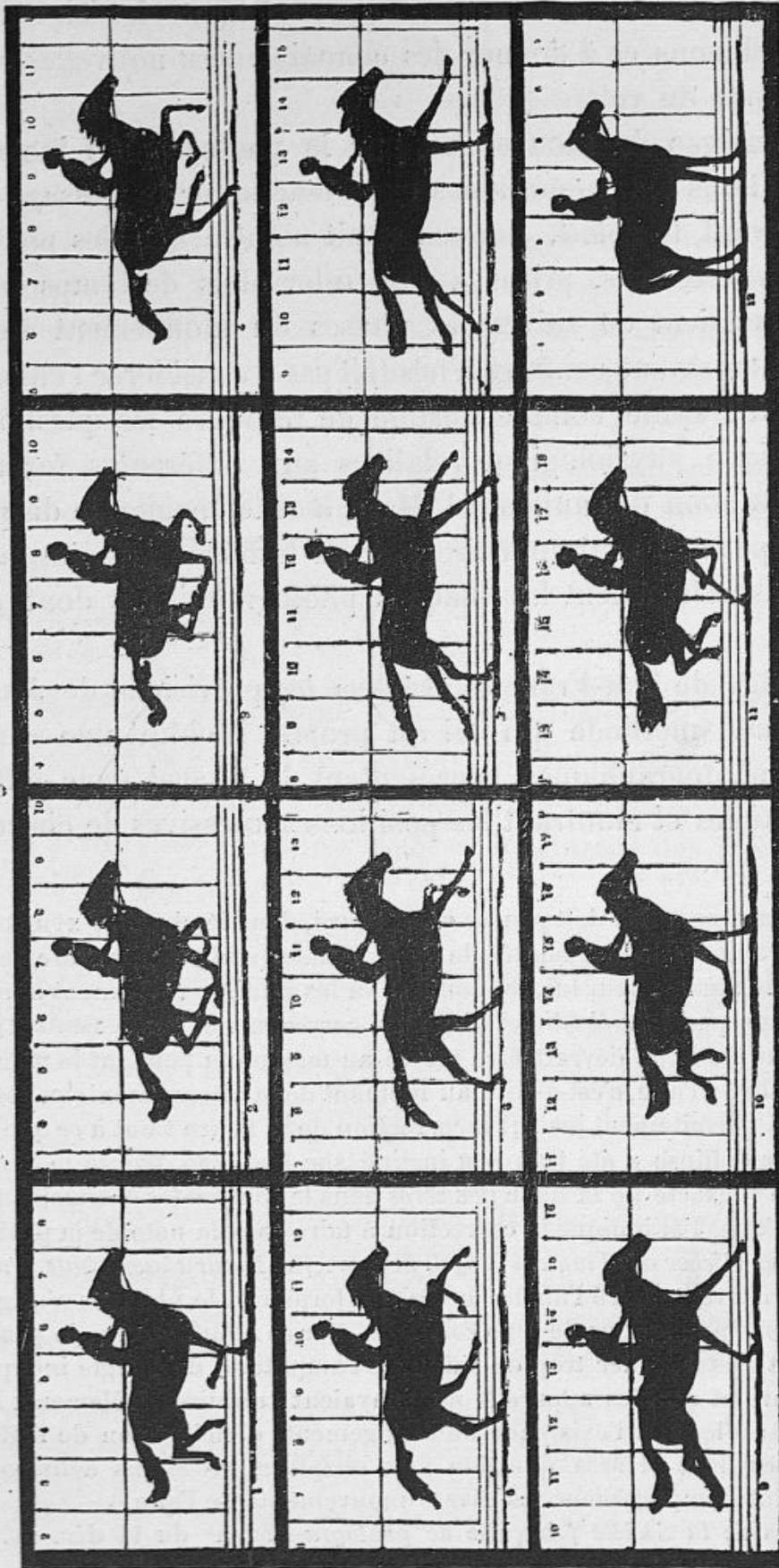
Fig. 67. — Photographies instantanées de Muybridge montrant en silhouettes les attitudes successives d'un cheval au galop. La première image est en haut et à gauche. Les divisions verticales tracées sur le fond blanc de l'écran sont écartées l'une de l'autre de 0m,56; ces repères servent à mesurer la vitesse de translation et l'étendue des mouvements des membres.
