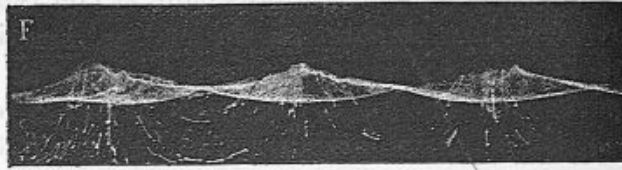
Fig. 66. — Mouvement des molécules dans une série d'ondes de clapotis à courte période.
