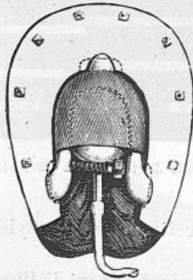
Fig. 5. — Explorateur des appuis des pieds du Cheval sur le sol ; un tube de transmission fait communiquer la chambre à air avec le tambour du chronographe.
