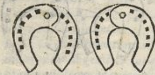
Ferri detti disferre, che sono di due pezzi, con vna brocca nel mezzo della punta.
