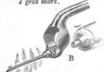
L'aiguille prise par le petit mors va être fixée sur le canon de la seringue.
