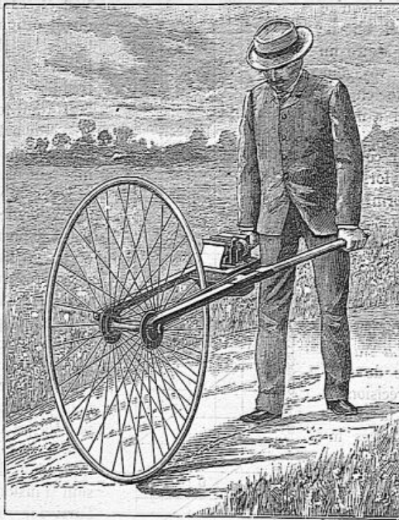
Fig. 5. — Marcheur poussant devant lui l'odographe.
