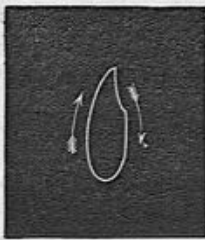
FIG. 108. — Tracé dans l'espace par l'extrémité de l'aile (abstraction faite de la translation de l'oiseau).
