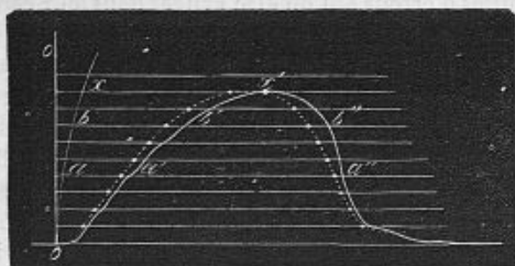
FIG. 337. — Correction de l'arc de cercle dans un graphique.
