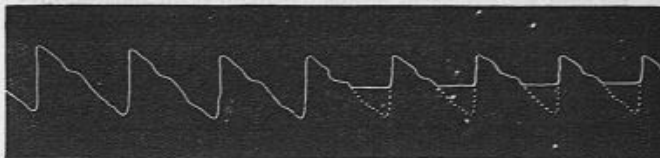
FIG. 339. — Graphique pour vérifier les indications des sphygmographes.
