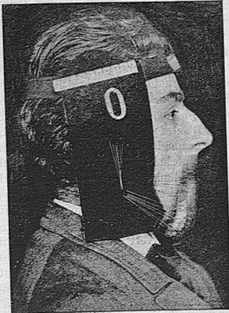
Fig. 57. — L'acte d'ouvrir la bouche produit des déplacements du maxillaire inférieur que traduisent exactement les déplacements de la tige brillante.
